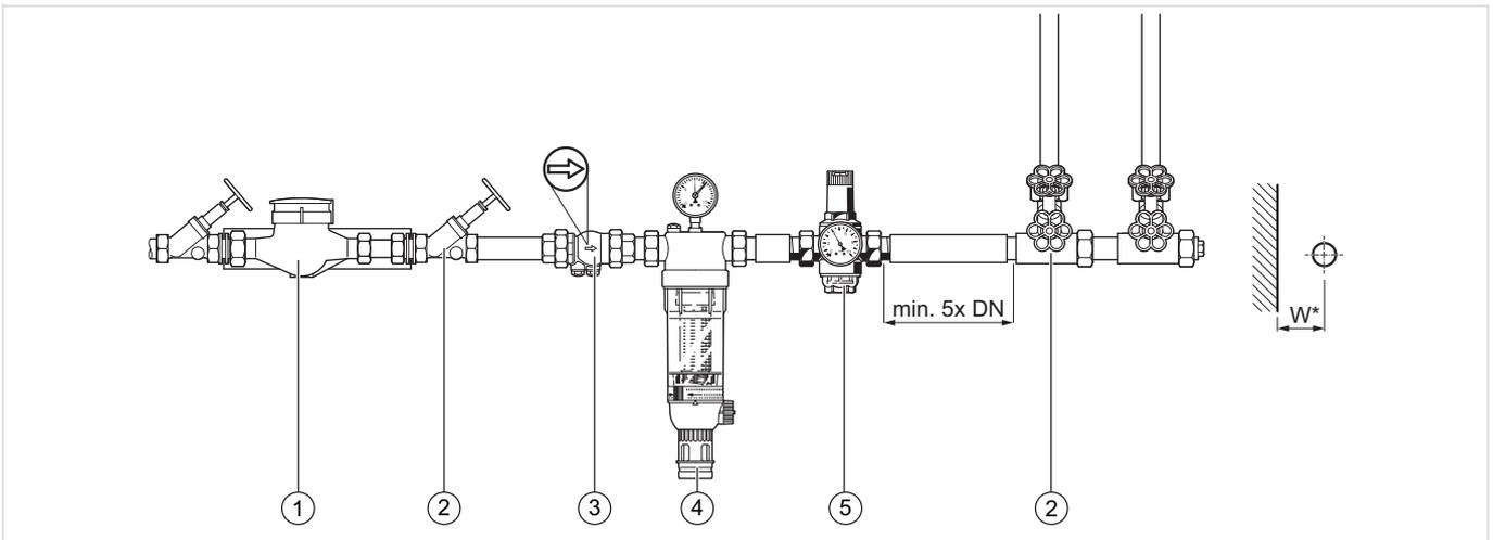
Abb. 1 Beispiel für den standardmäßigen Einbau für Druckminderer
