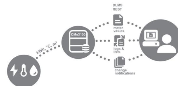
Abb. 2: Gateway-Integration mittels DLMS / REST-Server
