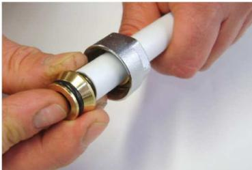
Der Verschraubungskörper ins Rohr einsetzen, mit der Spitze um Beachtung die zwei O-Ringe nicht zu beschädigen.
