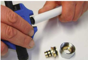
Das Rohr mit einem geeigneten Werkzeug schneiden, um einen schnellen und genauen Schnitt zu erhalten.
