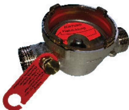
L'élément de montage pour UltraMaXX se monte aussi bien horizontalement que verticalement dans les tuyauteries de retour. Il reste durablement connecté à l'installation. La sonde de température de retour peut être montée dans l'élément de montage. Avant le montage ou après le démontage, monter le capuchon de décharge à la place du compteur de chaleur. Cela permet de procéder sans problème au débranchement ou au rinçage des tuyauteries.
