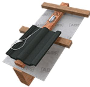
Sie suchen eine unscheinbare Alternative zum Dachhaken? Mit der Edelstahl-Anschlagschlaufe ABS-Lock Loop sichern Sie bis zu 3 Personen bei Arbeiten auf dem Dach. Das Edelstahlseil ( $\varnothing$  5 mm) wird auf dem tragenden Holzsparren verschraubt und ist nach der Montage kaum zu sehen.
