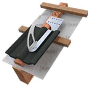
Eine Grundplatte mit 12 Bohrlöchern macht die Montage des ABS-Lock DH05 besonders flexibel. Der Dachhaken wird mit nur 2 Schrauben im tragenden Balken verschraubt und so ausgerichtet, dass er perfekt in die Wölbung der Ziegel passt. Die benötigten Edelstahlschrauben sind im Lieferumfang enthalten.
