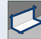
4. Auf das von hinten durchtränkte Vlies wird die Nachlage von ca. 1/3 LIQUISEAL 1C SF Abdichtung bis zur vollständigen Sättigung aufgebracht.
