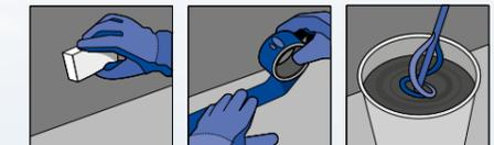
2. Das 1-komponentige Material wird direkt aus dem Gebinde verarbeitet. Ca. 2/3 der Flüssigabdichtung LIQUISEAL 1C SF werden vorgelegt.
