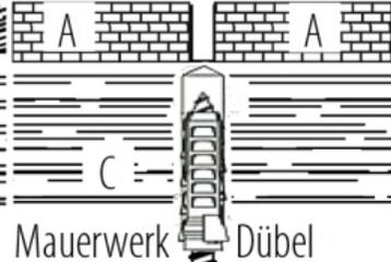
**2** Dübel auf Top Star aufsetzen und mit ins Bohrloch einschrauben
