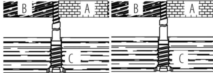
**4** Bit & Krone auf Top Star aufsetzen und bündig zur Oberfläche eindrehen.
