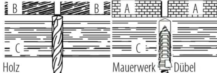
**1** Holz oder Mauerwerk zur Vorbereitung mit 8 mm Ø vorbohren
