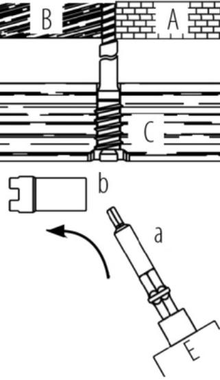
**5** Für die Feinstellung - Justage- die Krone abziehen und den Bit direkt in den Kopf der Top Star einsetzen.
