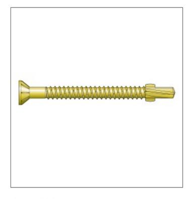
Les vis en bandes FHSD45E et FHSD64E simple filetage ont été étudiées pour faciliter la mise en oeuvre de contreplaqué et panneau bois sur structure acier ou aluminium (épaisseur 4 mm). La tête fraisée crantée n'endommage pas le bois et permet une finition parfaite.
