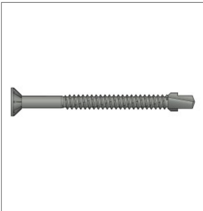
Die magazinierten TBG-Flügelbohrschrauben mit Feingewinde sind geeignet für die Montage von Holzplatten auf Metall- oder Aluminiumunterkonstruktionen bis zur einer Materialdicke von 4 mm.
