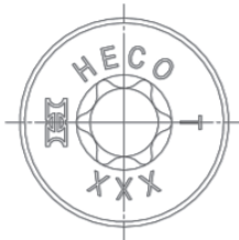
Kopfkennzeichnung bei d = 6,0 bis 10,0 der Ausführungen: Flachsensenkopf. Genannte Kopfform auch ohne Beschriftung möglich.
