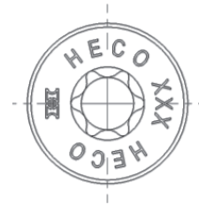
Kopfkennzeichnung bei d = 7,0 bis 10,0 mm aller Kopfausführungen. Kopfformen auch ohne Beschriftung möglich.
