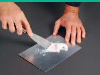
Mit einem geeigneten Spachtel werden die Füllmasse und der Härter gut vermischt. (Verarbeitungszeit nach Mischen: ca. 10 Min.)
