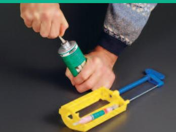
Öffnen der Kartusche mit spitzem Werkzeug, abbrechen des Härter-Verschlusses (Spitze) und einlegen ins Dosiergerät. Nach Gebrauch Kartusche mit Maler-Klebband verschliessen.
