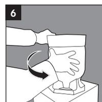
**6** Rotation dans le sens inverse des aiguilles d'une montre jusqu'à ce que la bonbonne soit déverrouillée.
