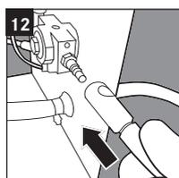
**12 Raccorder le tuyau à air comprimé.**
