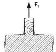
Bemessungswerte der Tragfähigkeit  $F_{1,Rd}$  und resultierende Axialbeanspruchung je Dübel bzw. Bolzen  $F_{Bo,ax,Rd}$  für Stahl- bzw. Beton-Holz-Verbindungen bei Anordnung von einem Verbinder und 1 Bolzen/Dübel
