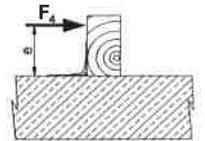
Bemessungswerte der Tragfähigkeit  $F_{4,Rd}$  und resultierende Axialbeanspruchung je Dübel bzw. Bolzen  $F_{Bo,ax,Rd}$  für Stahl- bzw. Beton-Holz-Verbindungen bei Anordnung von einem Verbinder und 1 Bolzen/Dübel
