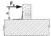
Bemessungswerte der Tragfähigkeit  $F_{4,Rd}$  und resultierende Axialbeanspruchung je Dübel bzw. Bolzen  $F_{Bo,ax,Rd}$  für Stahl- bzw. Beton-Holz-Verbindungen bei Anordnung von einem Verbinder und 2 Bolzen/Dübel
