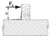
Bemessungswerte der Tragfähigkeit  $F_{4,Rd}$  und resultierende Axialbeanspruchung je Dübel bzw. Bolzen  $F_{Bo,ax,Rd}$  für Stahl- bzw. Beton-Holz-Verbindungen bei Anordnung von einem Verbinder und 1 Bolzen/Dübel
