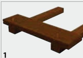
1. Erstes Brett: Mit geeigneten Schrauben befestigen, die sichtbar bleiben oder mit Hilfe des entsprechenden Zubehörs (siehe Kapitel Tools) verdeckt montiert werden.
