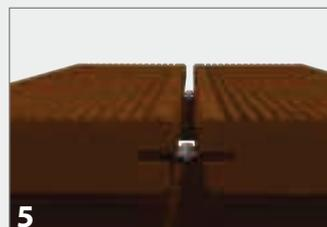
5. Den Verbinder mit der entsprechenden Schraube an dem darunter befindlichen Balken befestigen.
