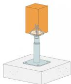
PPC Stützenfüße sind für Stützen und zur Aufständigung von Wandkonstruktionen bei Holzbreiten ab 100mm Breite geeignet. Eine Höhenverstellung ist im Bereich von 130-190mm bis 280-340 möglich. Der Stützenfuß ist nachträglich höhenverstellbar.
