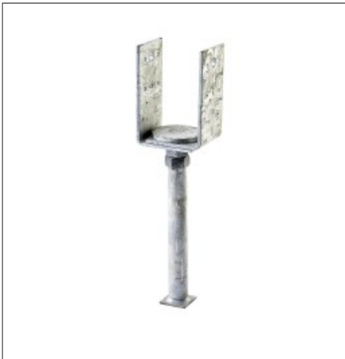
Die höhen- und seitenverstellbaren PVD Stützenfüße können für alle Holzbreiten zwischen 80-120/120-160 mm verwendet werden. Die PVD sind zum Einbetonieren.
