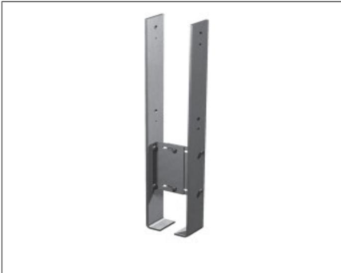
CMR Stützenfüße bestehen aus zwei außenliegenden Stahlteilen, die über ein Mittelstück stufenlos von 115 – 165 mm der entsprechenden Stützenbreite angepasst werden können. Sie sind für die Verwendung von Außenbauteilen geeignet.
