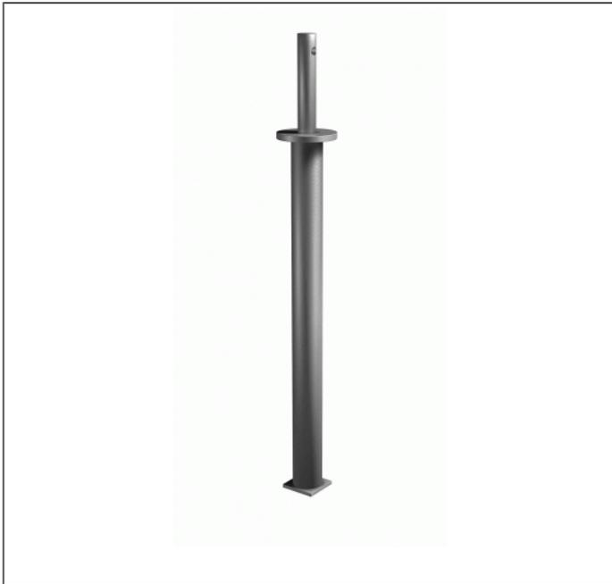
Die Stützenfüße sind zur Aufnahme von vertikalen Lasten geeignet und werden einbetoniert. Die Anbindung des PDs an die Stütze erfolgt durch eine Bohrung  $\varnothing 24$  mm. Durch die kraftschlüssige Verschraubung ist eine konstruktive Zugverankerung gewährleistet.
