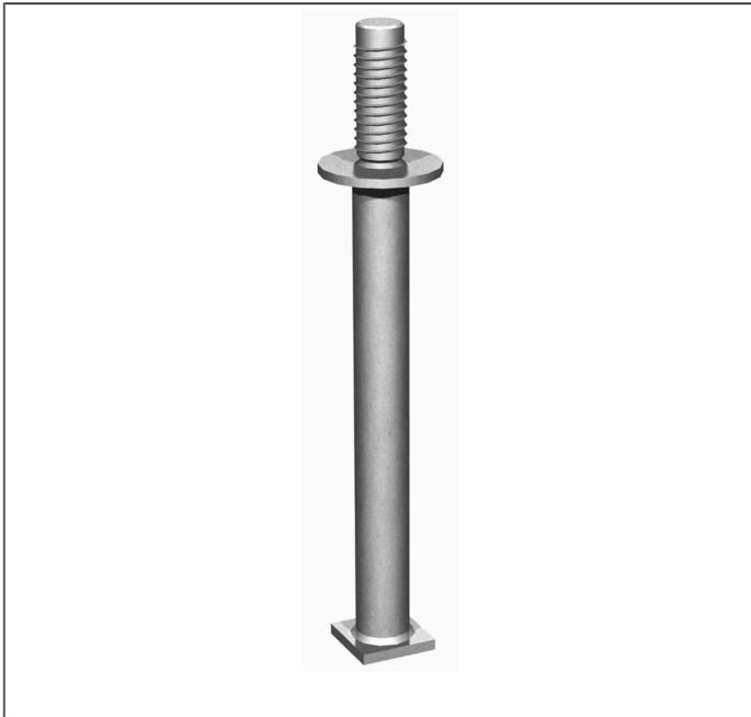
bestehen aus einem Kopfteil mit Spezialgewinde, das eine einfache Montage und hohe Auszugswerte gewährleistet. Der Typ CPS ist mit einem festen Rohr versehen. Die Stützenfüße sind für den Anschluss von Holzstützen aus NH oder BSH mit einem Querschnitt ab 12×12 cm geeignet. Der Anschluss erfolgt von der Stirnseite, seitlich sind keine Verbindungsmittel zu sehen.
