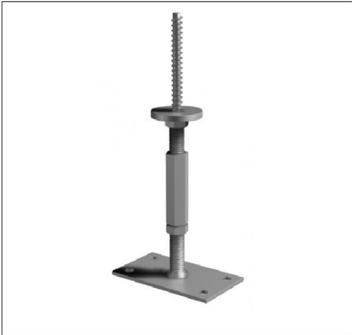
Die Stützenfüße sind zur Aufnahme von vertikalen Lasten geeignet und werden einbetoniert oder mittels Ankerbolzen am Betonfundament angeschlossen. Bei abhebenden Lasten ist ein Stabdübel Ø10mm einzubauen. Das 16 mm Spezialgewinde wird in eine Ø12 mm Bohrung bis zum Kontakt mit der Druckscheibe eingedreht. Durch die kraftschlüssige Verschraubung ist eine konstruktive Zugverankerung gewährleistet.
