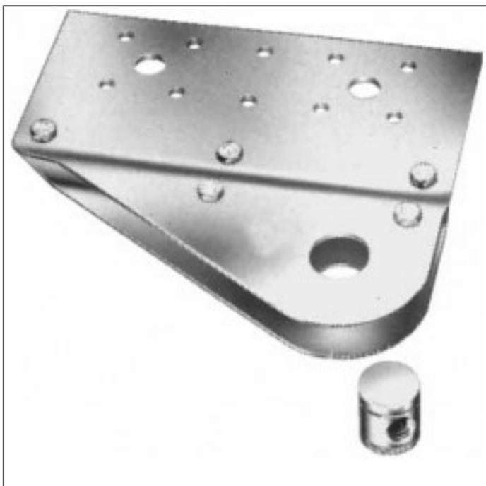
Die Windverbandanschlüsse ermöglichen einen flexiblen Anschluss von Stahl diagonalen z. B. in einer Holzhallenkonstruktion. Die Verbinder werden in die Dachträger eingeschlitzt und mit Stabdübeln angeschlossen. Der Diagonalenanschluss erfolgt über ein Quergewindebolzen M16 im Verbinder. An diesen Bolzen werden über Adapter und Spannschlösser die Windrispenbänder oder Rundstahldiagonalen angeschlossen.
