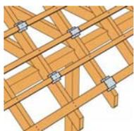
Mit den DLV Dachlattenverbindern können Dachlattenstöße auf Tragkonstruktionen, unter Einhaltung der Mindestrandabstände für die Nägel, normgemäß hergestellt und auf dem Sparren verankert werden. Anwendung finden sie auf schmalen Sparren, wie z.B. bei Nagelplattenbindern. Die DLV Dachlattenverbinder sind in alle Achsrichtungen belastbar.
