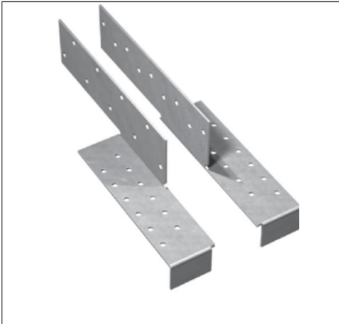
Diese Sparrenfußverbinder werden satzweise (rechts + links) an Binderuntergurt und Fußschwelle bzw. an Sparren und Pfetten befestigt.
