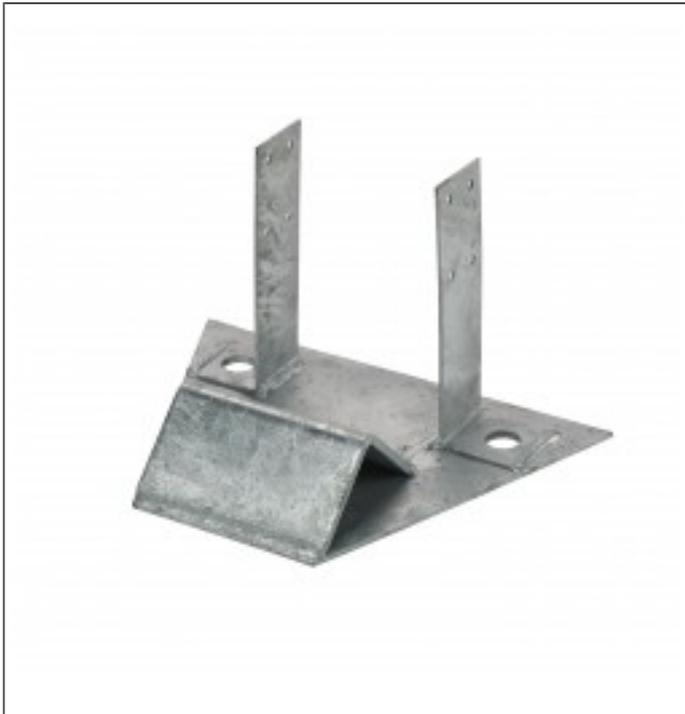
Die SHB Sparrenhalter für Anschlüsse an Beton werden für die Befestigung von Sparren mit einer Neigung von 30° bis 60° am Fußpunkt verwendet.
