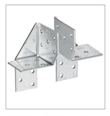
Die UNI Verbinder werden für Holz / Holzanschlüsse verwendet. Je Anschluss sollten zwei Verbinder diagonal gegenüberliegend angeordnet werden.Bei 2 diagonal angebrachten Verbindern pro Anschluss werden entweder 2 linke oder 2 rechte Verbinder benötigt.
