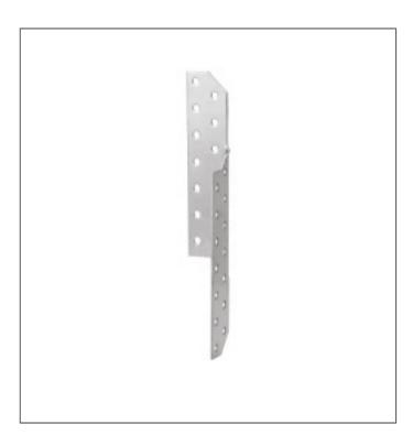
Die SPF Sparrenpfettenanker werden für die Zugverankerung von sich kreuzenden Hölzern verwendet. Ebenso können horizontale Kräfte aufgenommen werden. Belastungsabhängig kommen 2 oder 4 Pfettenanker pro Anschluss zur Anwendung. Bei 2 Pfettenankern pro Anschluss werden 2 linke oder 2 rechte Verbinder benötigt, da diese diagonal gegenüberliegend angeordnet werden sollten, um eine mittige Lasteinleitung zu gewähren.Eine Querzugbeanspruchung der Hölzer ist zu beachten und ggf. nachzuweisen.
