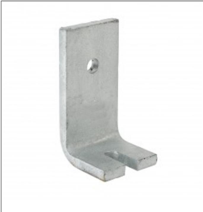
Die Betonwinkel werden aus 8mm dicken Stahlbändern hergestellt und sind rundum feuerverzinkt. Die "ABS" haben ein Bolzenloch im vertikalen und einem Schlitz im anderen Schenkel. Sie sind preisgünstige Alternativen zu Verbindern, die aus gewalzten Winkelprofilen hergestellt werden.
