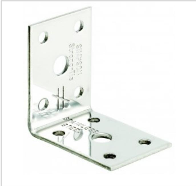
Die Winkelverbinder werden für Holz / Holz oder Holz / Beton Anschlüsse in konstruktiven Bereichen eingesetzt. Für eine gleichmäßige Lasteinleitung werden zwei Winkel je Anschluss empfohlen. Die rostfreien Standardholzverbinder können in Konstruktionen eingesetzt werden, an die besondere Anforderungen an die Korrosionsbeständigkeit gestellt werden
