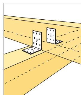
Die Winkelverbinder werden für Holz / Holz Verbindungen mit kleineren Holzabmessungen eingesetzt.
