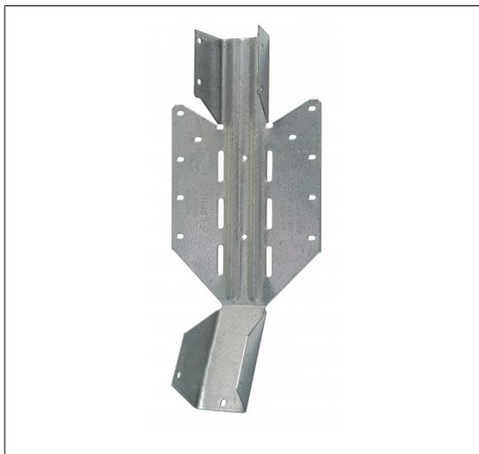
L'étrier à pente et orientation réglables LSSU est un étrier qui permet de régler sur chantier l'angle et la pente nécessaires pour sa mise en oeuvre jusqu'à 45° dans les 4 directions.
