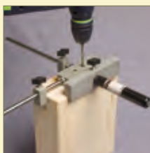
Bohrposition übertragen und bohren
