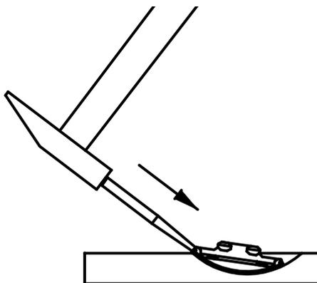
Mit Hilfe des Einschlagwerkzeuges den Verbinder genau positionieren
