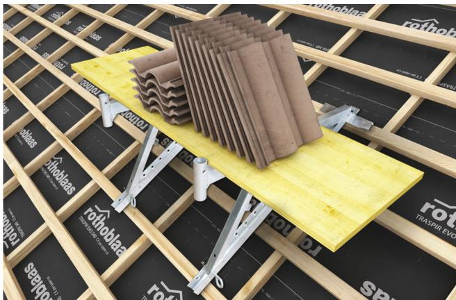
Les MULE sont utilisés comme plateau de stockage temporaire pour matériaux divers (tuiles, panneau isolant..) ou machines sur des toits inclinés entre 15° et 60° (mini 27%).
