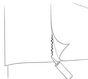
Scellement recouvrements de membrane à la colle
