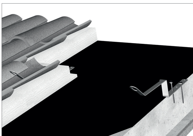
Montaggio su tetto in cemento
