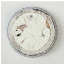
Bruchbild 1 (kohäsiver Bruch bei guter Haftung)
