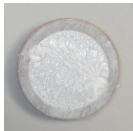
Bruchbild 2 (Hohlräume in der Kleberschicht)
