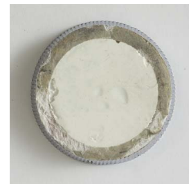
Bruchbild 4 (keine Haftung z.B. bei Trennmittelschicht)
