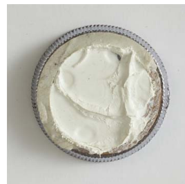
Bruchbild 3 (zu geringe Haftung z.B. bei nicht ausrei- chender Aushärtezeit)
