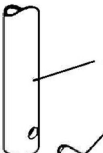
Stahlrohr 25x680 mm
