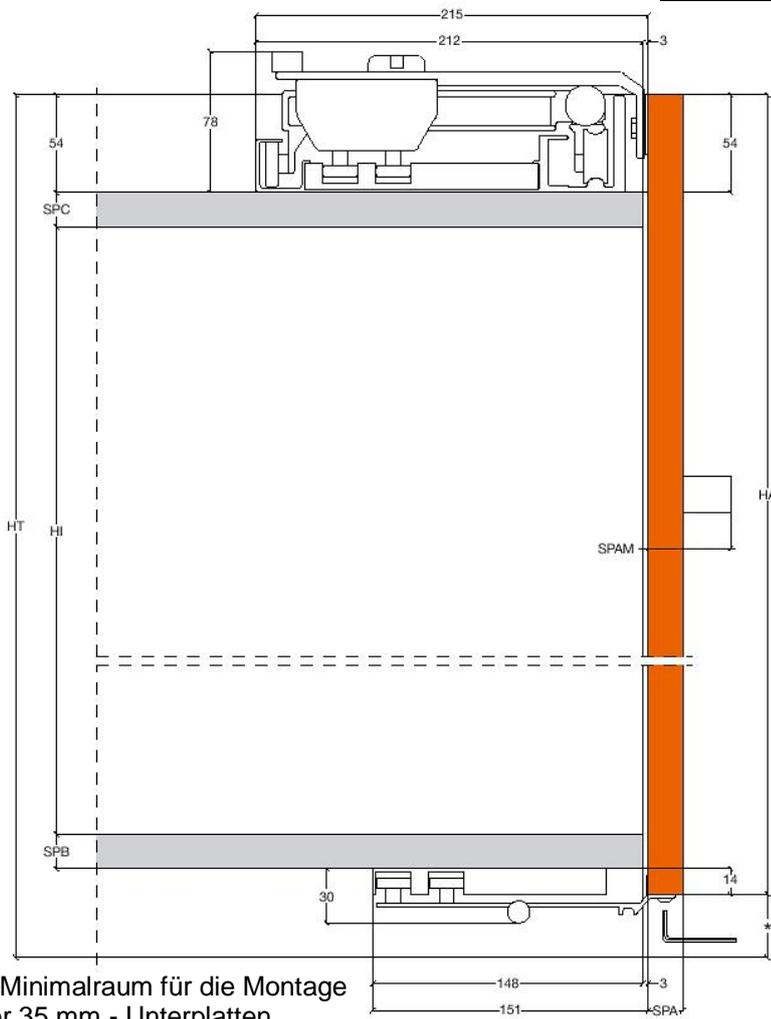
\*) Minimalraum für die Montage der 35 mm - Unterplatten
