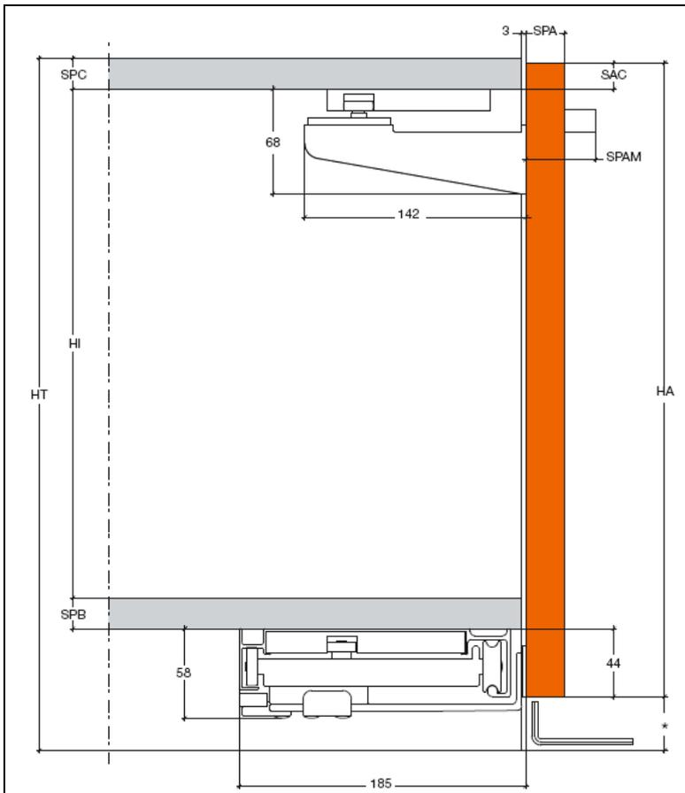
\* Spazio minimo mm 35 per fissaggio e regolazione
