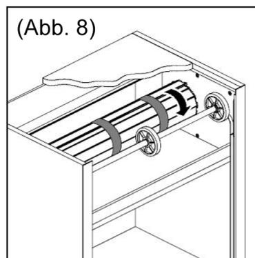
Zur Aktivierung des Gewichtsausgleiches wird zum Abschluss der Montage die integrierte Feder der Rollladenbox vorgespannt. Die noch aufgewickelte Matte wird in Pfeilrichtung gedreht (Abb. 8).
