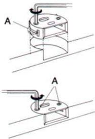
Klemmscheibe A nach innen drehen. Bandkörper einsetzen, ausrichten und fest eindrücken. Die seitlichen Haftscherwerer arretieren den Bandkörper im Holz.
