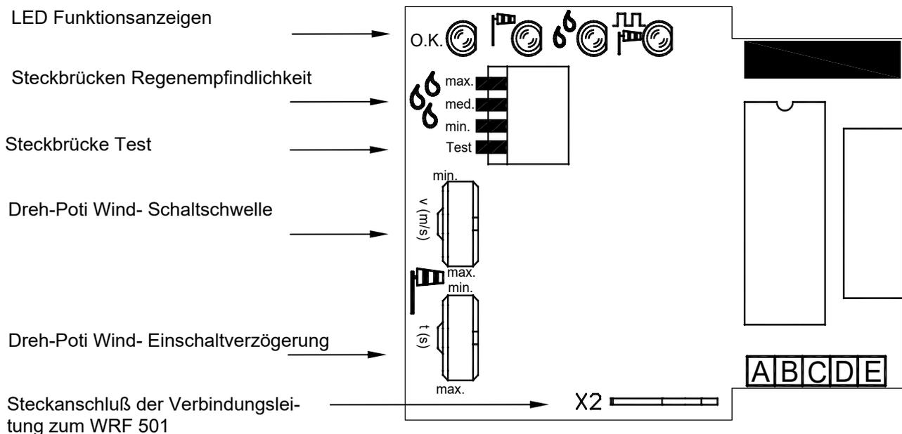
Abbildung 4: Ansicht des WR-MOD 501 ( Wind-/Regen- Modul )
