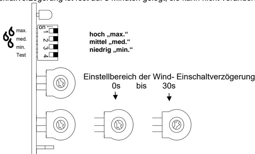
Abbildung 5: Ansicht des WR-MOD 501 Einschaltverzögerungszeit
