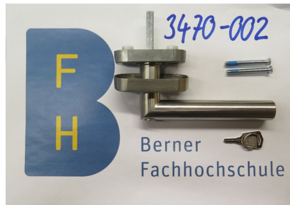
Prüfkörper 2: Griff abschliessbar
