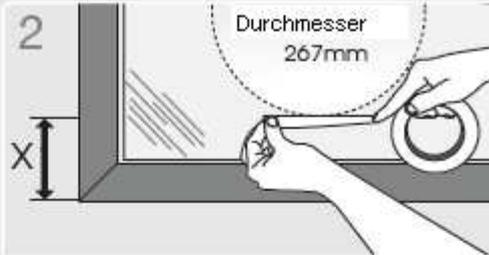
2 Markieren Sie diese Höhe (x) auf der Glasfläche mit Klebeband oder ähnlich. Über dieser Markierung wird das Loch ausgeschnitten.
