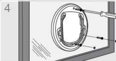
4 Fixieren Sie die 2 Rahmen mit den 3 beiliegenden Schrauben und Kunststoffklappen.
