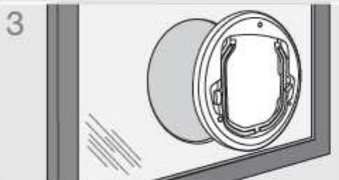
3 Äusseren Rahmen in das Loch schieben, anschliessend den innen Rahmen in den bestehenden Ausschnitt einfügen.
