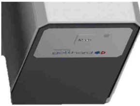
Figure 35 : Appuyez sur le bouton MODE pendant 10 secondes pour effectuer un RESET.
