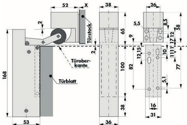
Maß X: Bei jedem Türdämpfer VS 2000 werden 3 Unterlegplättchen mitgeliefert, jeweils 1 Stück mit 2 mm, 3 mm und 10 mm Dicke. Damit können bei der Montage an aufliegenden Türen bis zu max. 15 mm Unterschied zwischen Tür und Türzarge ausgeglichen werden.
