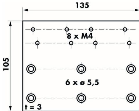
Montagewinkel für waagrechte Montage an gleichliegenden Türen
